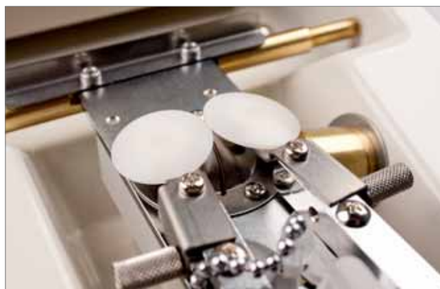
Beide glasvoorzieningen hebben elk een fijnjusteerbare kunststof rol voor de exacte positionering boven de groefschijf
