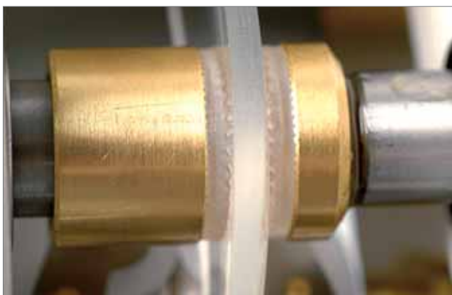
Zachte siliconen zorgen voor een goede grip op de glazen en een gelijkmatige drukverdeling bij het klemmen
