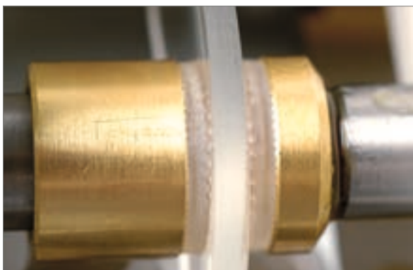
Zachte siliconen zorgen voor een goede grip op de glazen en een gelijkmatige drukverdeling bij het klemmen
