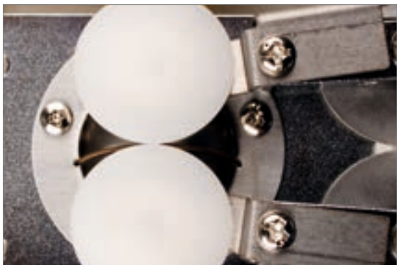
Grote, speciaal gelagerde aandrijfrollen maken ook het groeven op moeilijke glasvormen mogelijk
